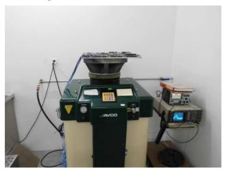
Shock diagram: 50g/20ms, 100mV/div, Sensor=10mV/g,  $5Div=\Delta V=50g$ Shock level=50g, skala (0-100)g, (0-1)V, 1V=100g, 0.5V=50g, Sensor Sens.=10mV/g
