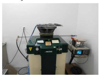
Shock diagram: 30g/18ms, 100mV/div, Sensor=10mV/g,  $3Div=\Delta V=30g$ Shock level=30g, skala (0-100)g, (0-1)V, 1V=100g, 0.3V=30g, Sensor Sens.=10mV/g
